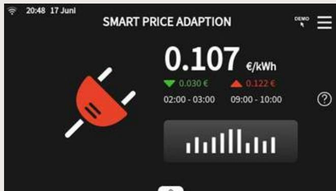
Nach der Aktivierung sehen Sie auf dem Display der Wärmepumpe den aktuellen Strompreis, sowie die günstigste und teuerste Stunde des Tages.
